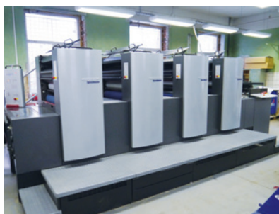
Флагман типографии «Павел» ВОГ машина Heidelberg Speedmaster SM 74
